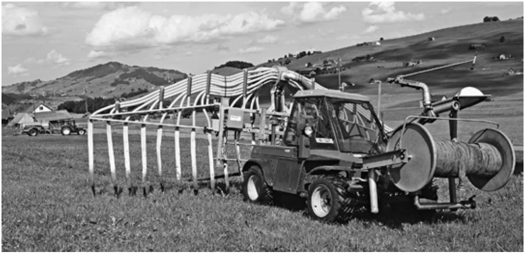
Schleppschlauch-Düngung zur Verminderung von Ammoniak-Emissionen.
